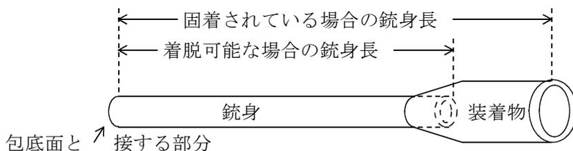
注2 包底面とは、薬室閉鎖位置にある遊底の薬莖底面と接する面をいう（写真4～9参照）。
